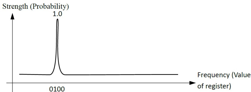
圖 4.16：在圖 4.12 中採樣了 16 個點的量子傅立葉逆變換之後，信號的頻率是具有四個量子位的量子寄存器的測量結果，其強度是讀出結果的可能性。
